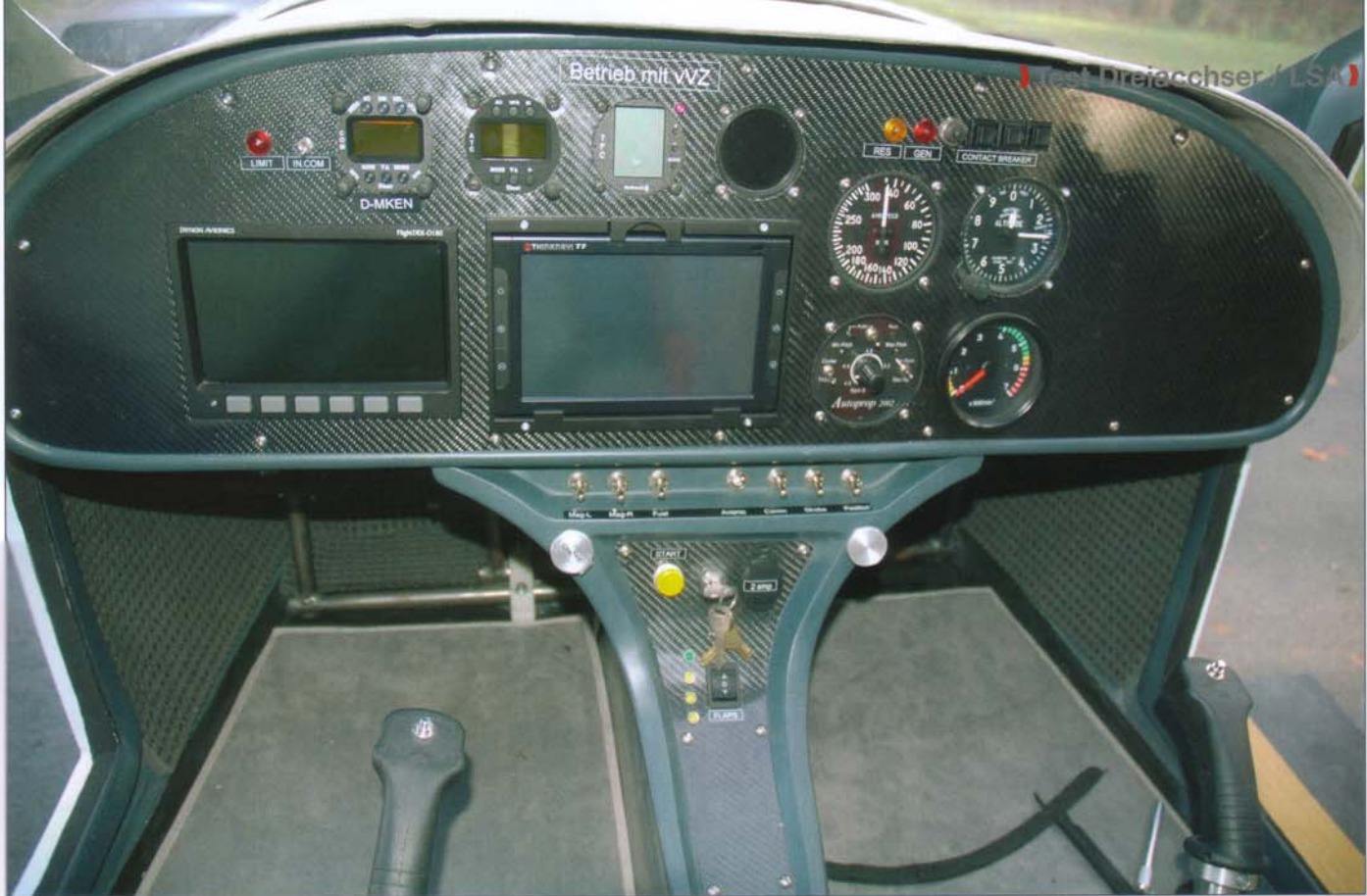
Das Instrumentenpanel ist komplett in Carbon gefertigt. Hier mit EFIS von Dynon, GPS, Transponder, Funk und das Kollisionswarngerät von Funkwerk (oben). Die Beringer Aluminiumfelge mit hydraulischer Scheibenbremse (rechts). Das ineinandergespresste Bugfahrwerk mit manueller Verstellung für Härte und Dämpfung (rechts unten).
